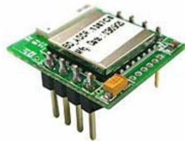
Abb. 3.25: Bluetooth-Modul mit SPP
